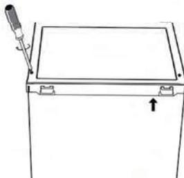
2. Con cuidado levantar la cubierta superior del congelador unos 5 cm, a continuación soltar los terminales. Retirar la cubierta superior
